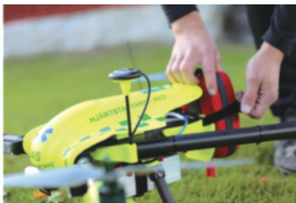
図：AED（右図の赤いバッグ）を搭載したドローン（Claesson A, et al. JAMA, 2017, 317 (22), 2332-4. より引用）。
